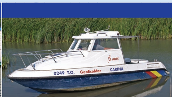
Șalupa de cercetare - inspecție "Carina": 6 m lungime, 6 locuri, motor Diesel de 150 CP
