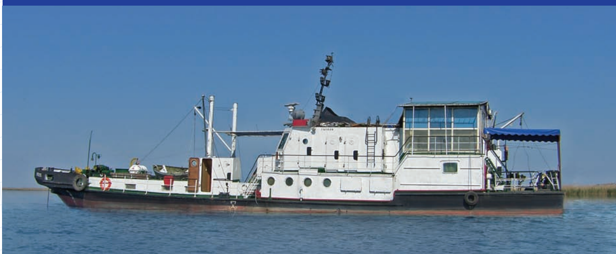
Nava de cercetări fluviale și costiere "Istros": deplasament 147.8 t, 10 locuri de cazare cercetători, 3 laboratoare, autonomie 900 km
